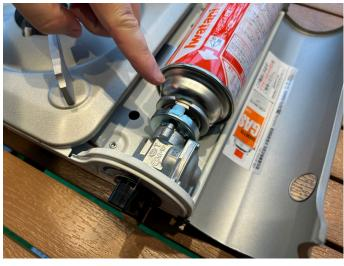
⑤切り込み凹部に合わせてボンベをセット します。
