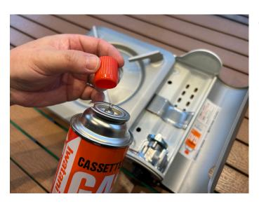
④ボンベのキャップを外します。※回さずに上に引き抜くタイプです。
